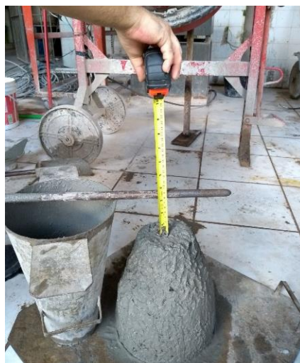
Figura 3.11. Consistência e trabalhabilidade (Slump test do Concreto). (Autoria, 2022).
