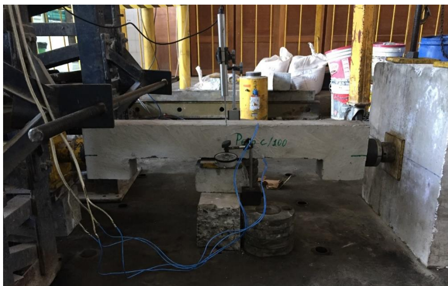
c) Sistema de ensaio montado – Pilar Pesp c/100
